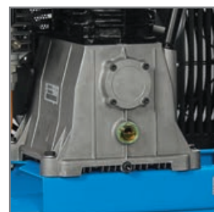
Olejoznak umožňuje snadnou kontrolu stavu oleje.
