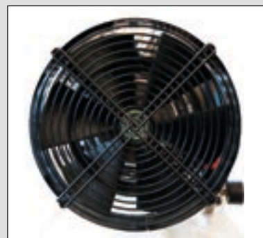
Přidaný ventilátor pro účinné chlazení kompresorové jednotky
