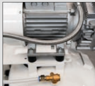
Pryžové podstavce pro snížení přenosu vibrací z kompresoru
