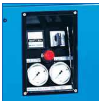
Centralizovaný panel včetně počítadla motohodin
