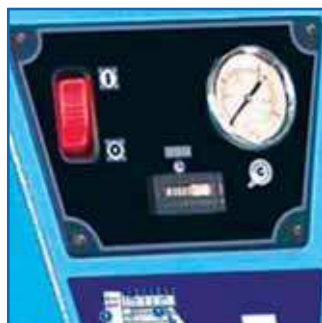
Centralizovaný panel včetně počítadla motohodin a signalizace poruch
