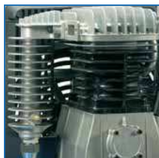
Masivní žebrování poskytuje optimální rozptyl teploty
