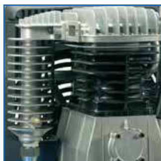
Masivní žebrovaní poskytuje optimální rozptyl teploty
