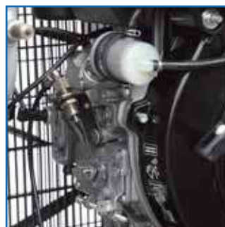
Kontrola otáček spalovacího motoru
