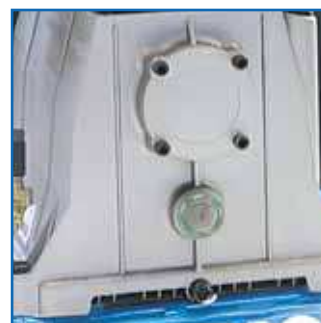
Olejznak pro snadný odečet hladiny oleje
