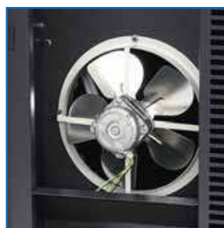
Extra ventilátor pro účinné chlazení větších strojů
