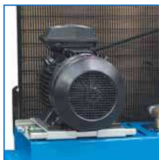
Snížení proudových špiček při startu díky Y-D přepínači
