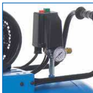
Řízení chodu tlakovým spínačem se zapínacím tlačítkem
