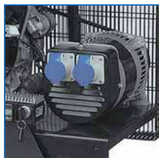
Elektrocentrála s příkonem 2,2 kVA pro dodávku elektrické energie
