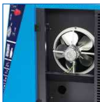
Extra ventilátor pro účinné chlazení větších strojů
