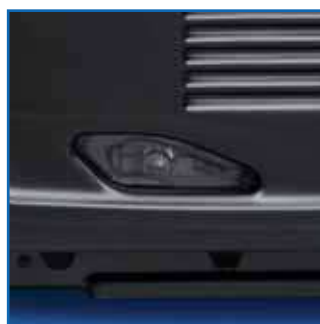
Olejoznak je umístěn z vnější strany krytu
