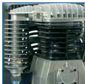
Masivní žebrování poskytuje optimální rozptyl teploty
